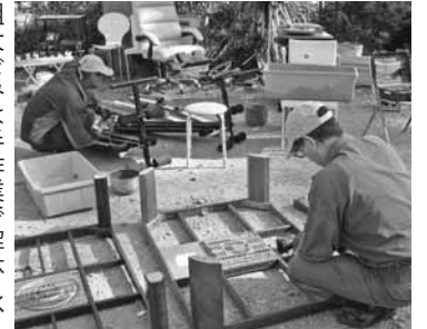
粗大ごみは手作業で解体し、リサイクル又は焼却処分する
