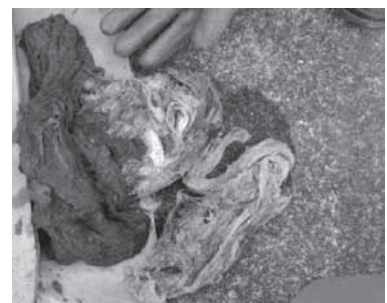
中継ポンプに絡まっていた布類
