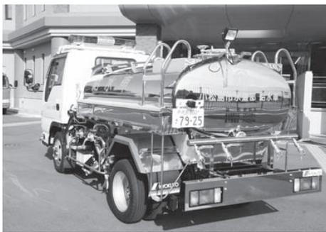
市水道部では、災害による断水時に応急給水が可能な給水車を導入しました。今回導入した「加圧式ポンプ」を装備した給水車は、一度に2千リットルの飲料水を運ぶことができます。
